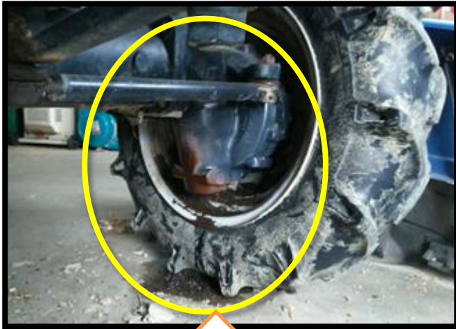
《油漏の有無》 機械の稼働部、配管、パイプ等から油が漏れていないかの確認
